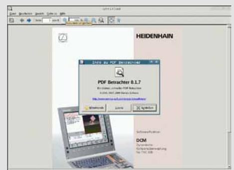
Открытие файлов в формате PDF непосредственно в системе управления: это стало возможным благодаря программе просмотра PDF-файлов.
