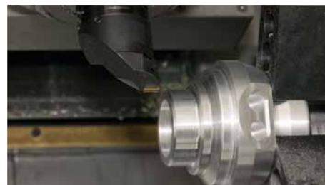
... продольное точение при помощи одного и того же инструмента.
