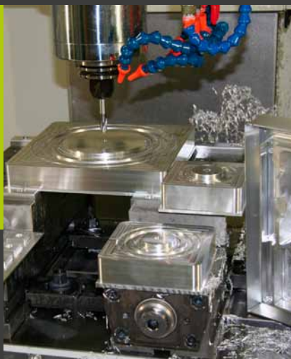
С помощью TNC 620 компании HEIDENHAIN обработка по трем осям реализуется эффективно и просто.
