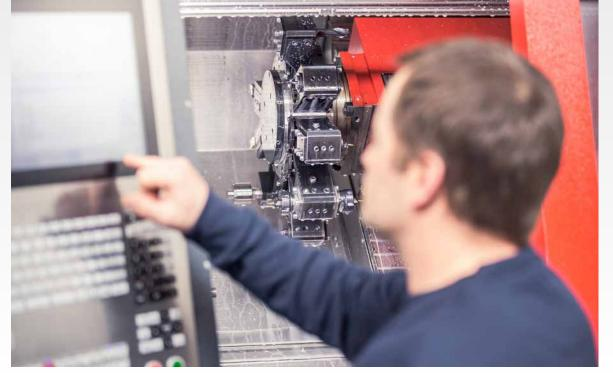
СПС PILOT 640 идеальная ЧПУ для токарных станков таких, как токарные обрабатывающие центры EMCOTURN, которая идеально раскрывает их сильные стороны в цеховом применении.
