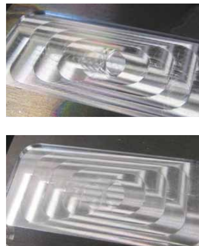
Comparaison : l'atténuation des à-coups de l'iTNC 530 réduit les marques sur les pièces.
