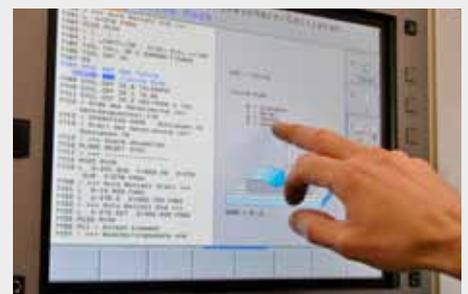
empresas pequeñas es muy importante conseguir una eficiencia elevada, en función de cada mecanizado se han de ajustar entre sí óptimamente la velocidad, la calidad de acabado de la superficie y la precisión. Se puede influir sobre este particular mediante el ciclo 332 del iTNC 530, con el que se pueden seleccionar valores de tolerancia y filtros preajustados.
