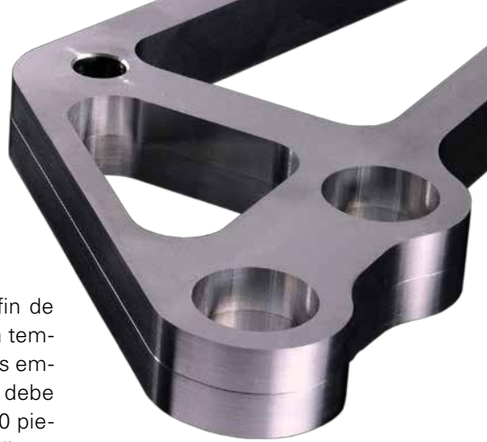
Claramente visible por el mecanizado doble: La discrepancia de 70 \mu m resultante del calentamiento del accionamiento por husillo de bolas
