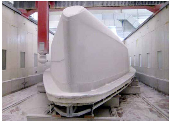
En el centro de mecanizado de Belotti se crea un molde del casco de 20,37 m de longitud con una tolerancia de tan solo 1 mm.
