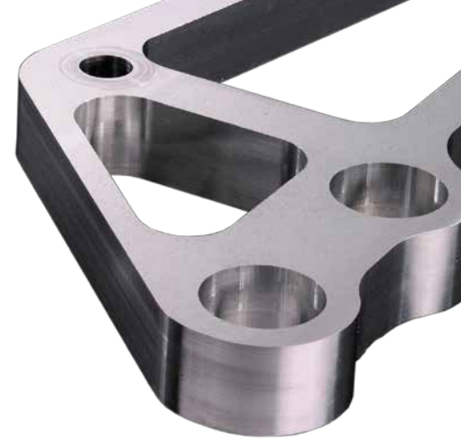
Segundo taladro no visible con Closed Loop: Una pieza doblemente mecanizada sin esquinas ni bordes
