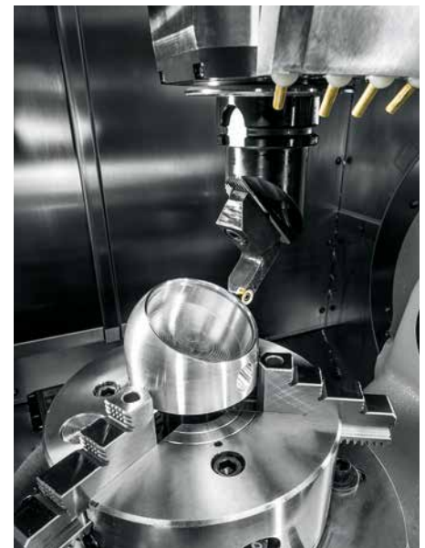
Torneado por interpolación: Con el TNC 640 es muy fácil y flexible con los ciclos 291 y 292 – incluso con el plano de mecanizado inclinado.
