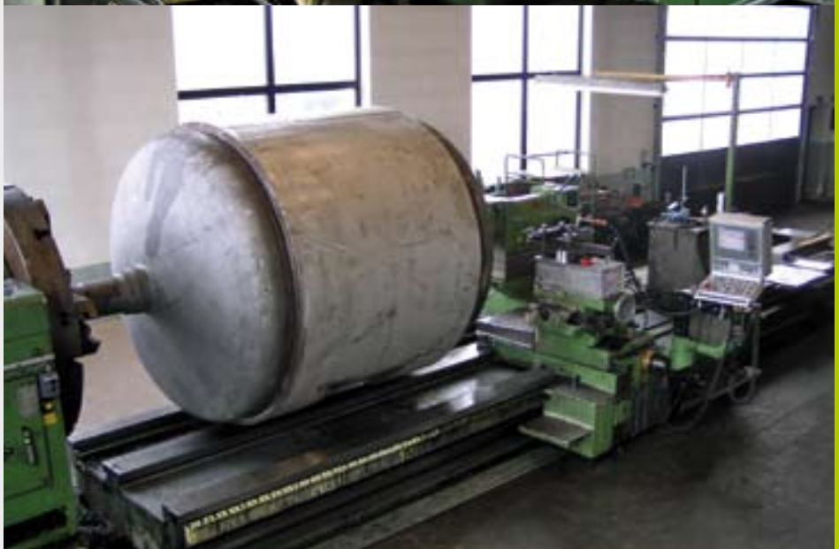
Fliegende Drehbearbeitung (oben) Bearbeitung einer Mischertrommel mit 2,1 m Durchmesser (unten)
