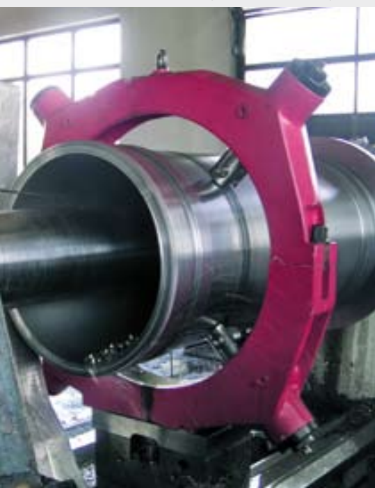
Rohr Innenbearbeitung für eine Zentrifuge
