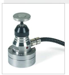
Das rotierende oder stehende Werkzeug lenkt das Tastelement des TT aus. Mittels integriertem optischen Schalter wird ein Schaltsignal erzeugt und an die CNC übertragen. Hier wird der Verschleiß dementsprechend kompensiert.
