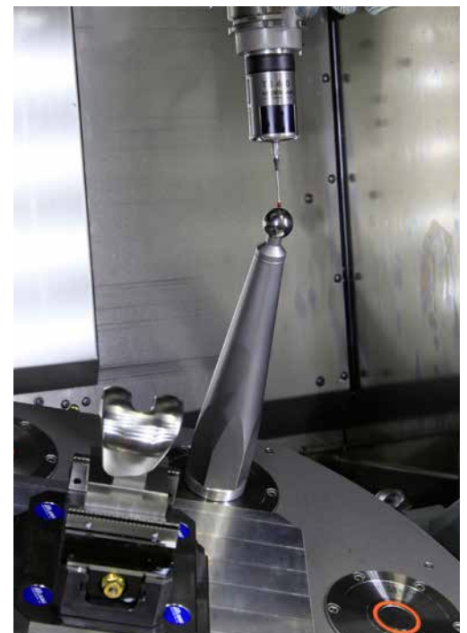
Medición más precisa con la opción 3D-ToolComp y el ciclo de palpación 444
