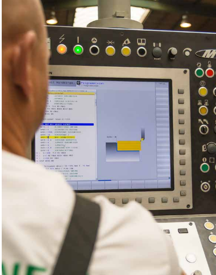
Tanto da si se torneado como fresado, mediante los ciclos del TNC 640, se programa rápidamente y se optimiza el mecanizado en el taller.
