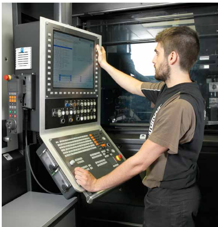
Los operarios pueden efectuar intervenciones manuales durante el mecanizado a través de los controles numéricos TNC.
