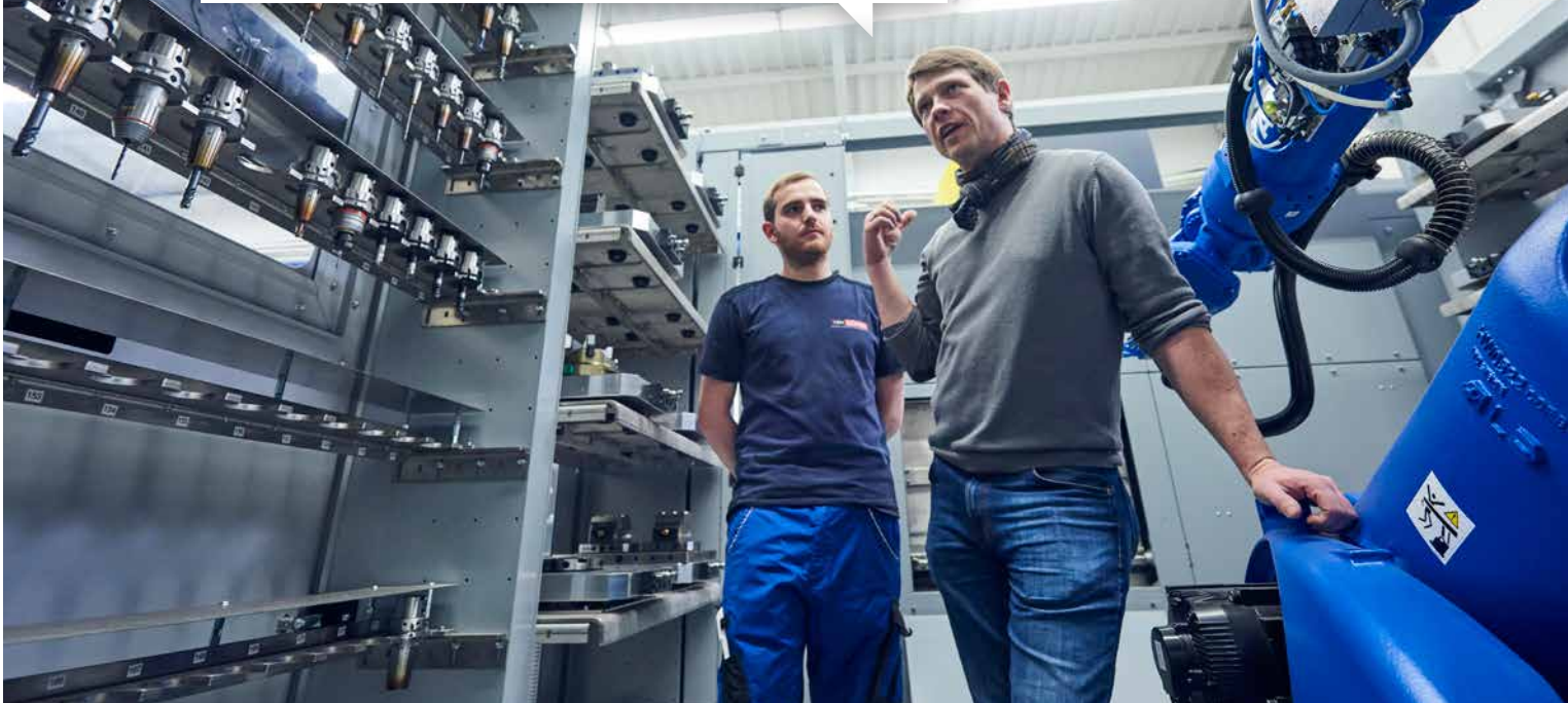
Phillip Schröder (links) und Dirk Schröder in der Roboterzelle mit kombiniertem Paletten- und Werkzeugwechselsystem
