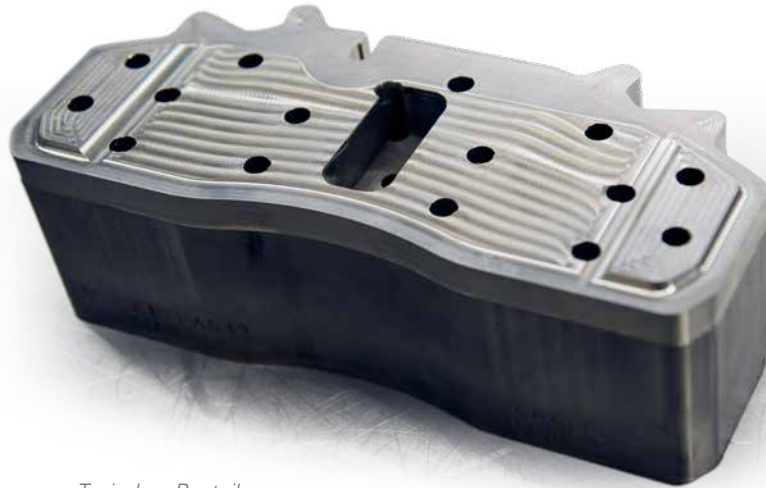
Typisches Bauteil: Die Form zum Stanzen einer Trägerplatte für Lkw-Bremsklötze ...
