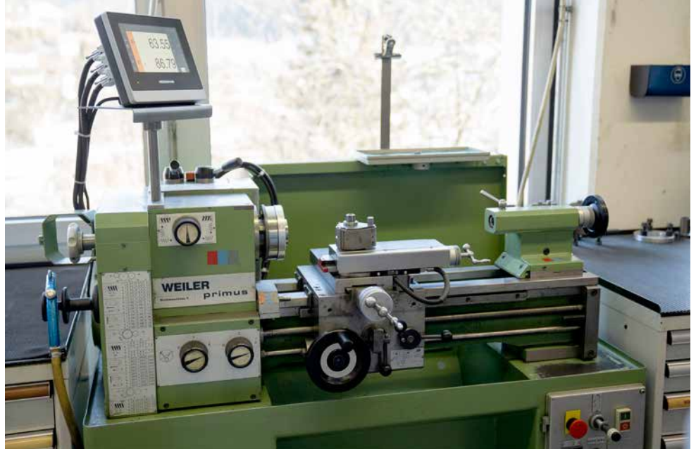
Insgesamt acht konventionelle, handbediente Maschinen wurden im Rahmen des Retrofits umgerüstet.
