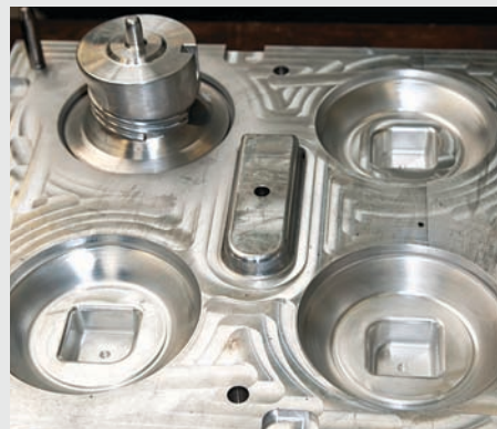
轮廓形状复杂的铸模用配TNC 620数控系统的机床轻松加工。
