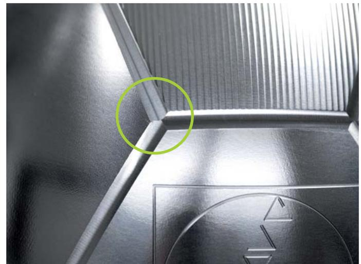
**Closed Loop:** grazie ai precisi sistemi di misura lineari e angolari di HEIDENHAIN gli errori del sistema meccanico di azionamento non hanno alcuna influenza sul risultato della lavorazione. La cucitura viene fresata nella larghezza corretta con un andamento preciso nelle giunzioni delle cuciture.
