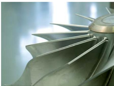
Per componenti di propulsori in acciaio la lavorazione a 5 assi è da tempo uno standard. Elevati requisiti di efficienza impongono un costante miglioramento delle caratteristiche di portata di tutti i componenti di un motore. Le geometrie derivanti sono molto complesse e pertanto realizzabili esclusivamente con movimenti di fresatura simultanea a 5 assi.
