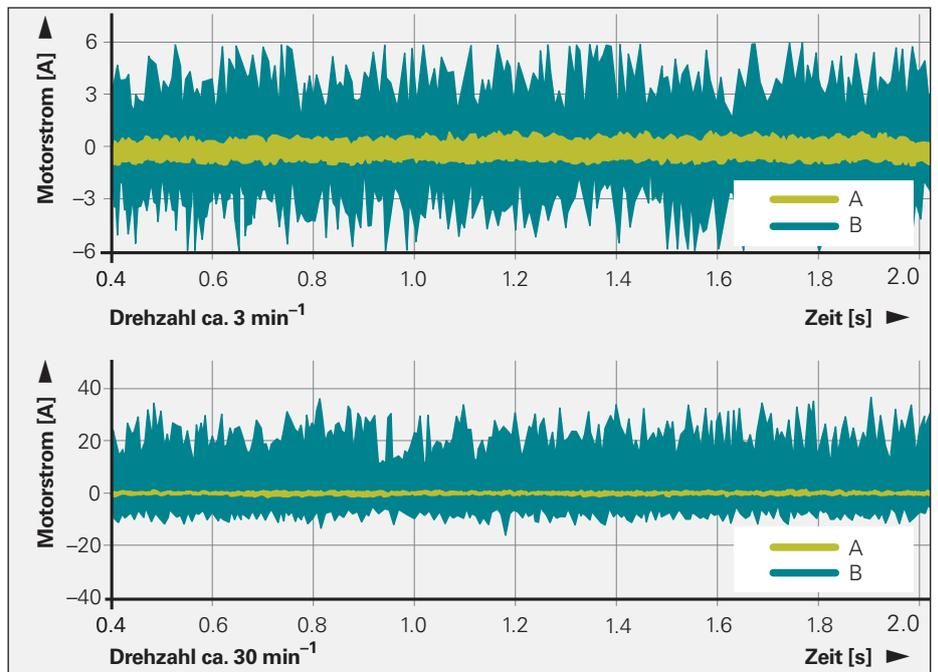
Motorstrom eines Direktantriebs bei Positionsmessgerät
