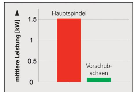
Mittlere Leistungsaufnahme der Antriebe beim Fräsen einer Kreistasche
