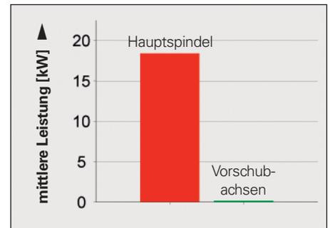
Mittlere Leistungsaufnahme der Antriebe beim Planschruppen
