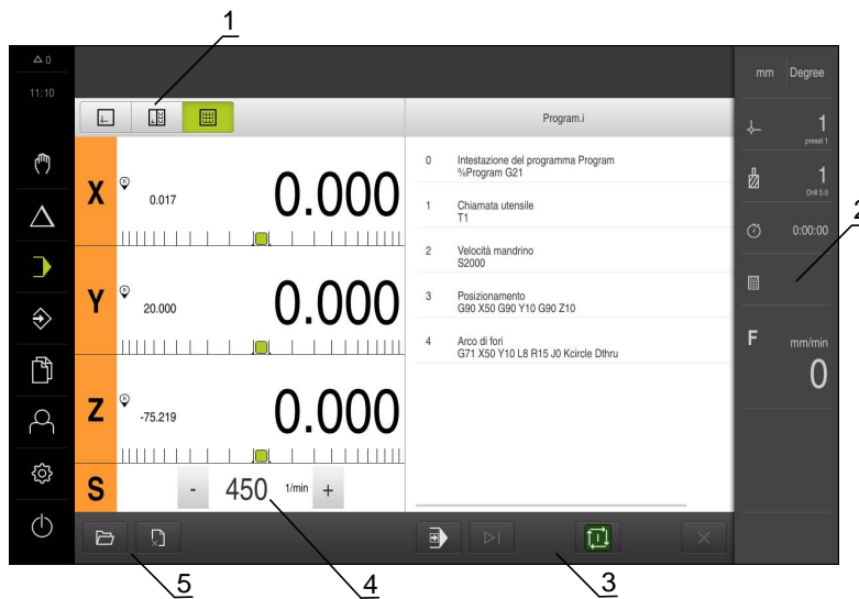
Figura 10: Menu Esecuzione programma nell'applicazione Fresatura
