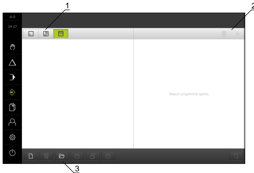
Figura 12: Menu Programmazione nell'applicazione Fresatura
