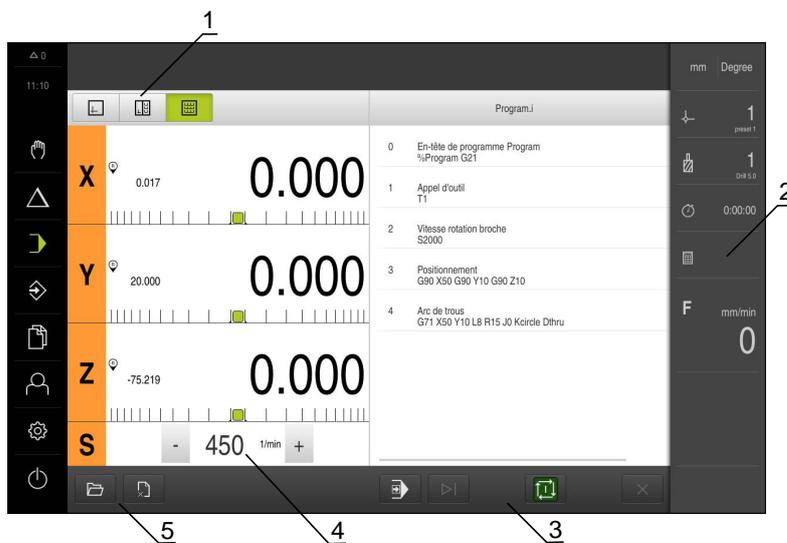
Figure 10 : Menu **Exécution de programme** dans l'application Fraisage
