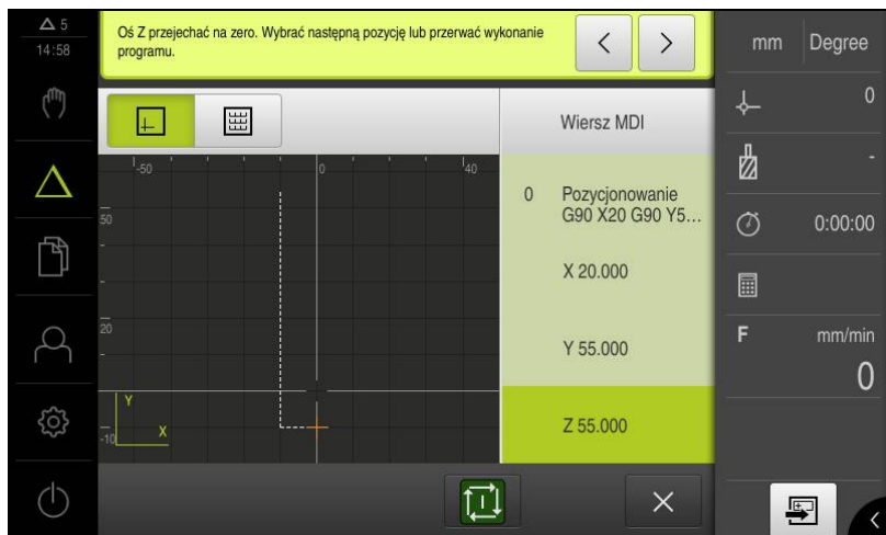
Ilustracja 64: Przykład – wykonanie bloku MDI ze współczynnikiem skalowania
