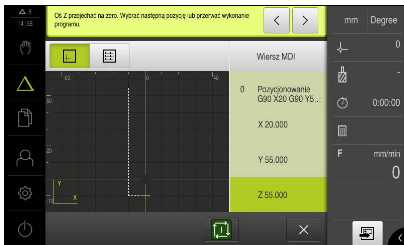
Ilustracja 57: Przykład – wykonanie bloku MDI ze współczynnikiem skalowania
