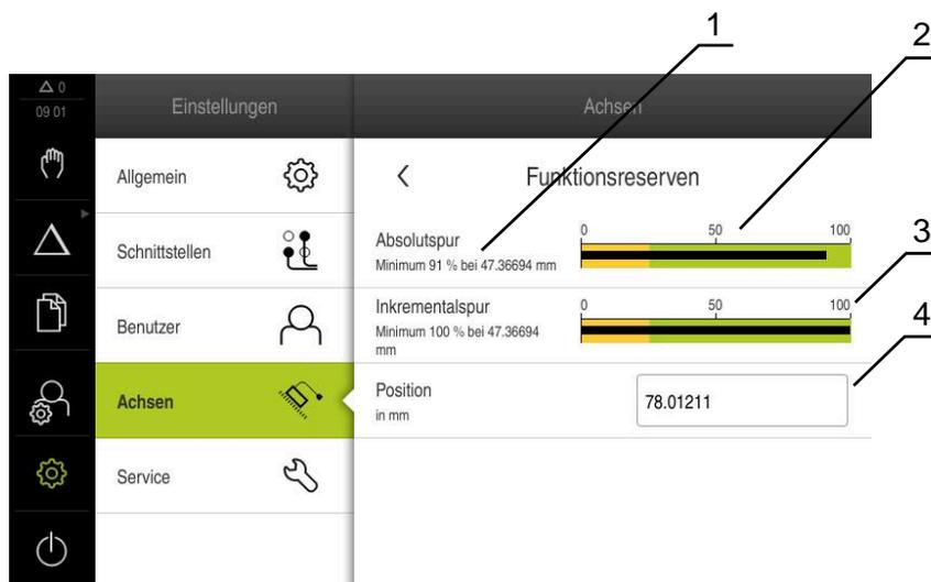
Abbildung 52: Beispiel von Funktionsreserven eines Messtasters
