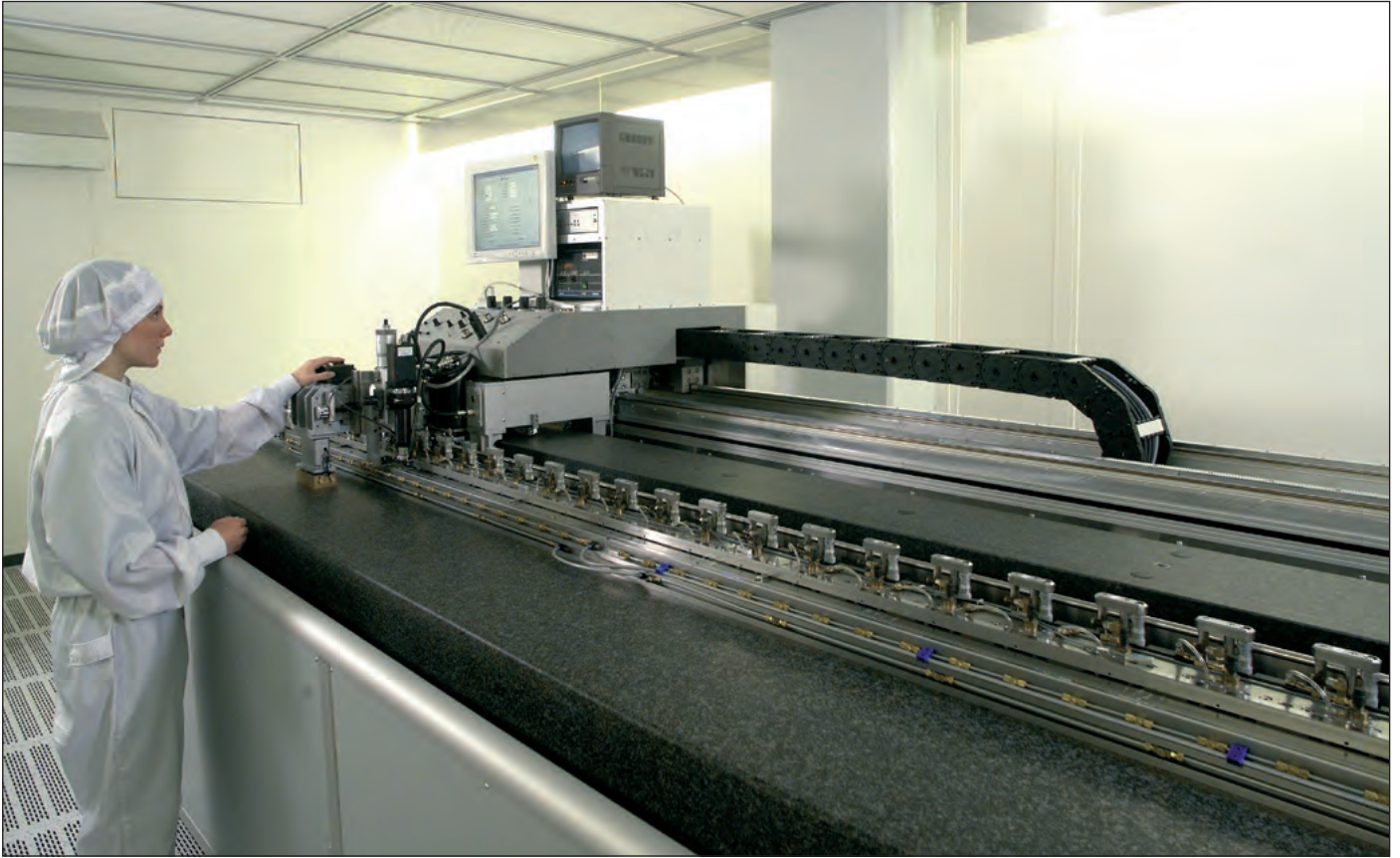
図9:オープンタイプリニアエンコーダの各スケールに対して、ハイデンハインは特別な測定装置を使用して規定ピッチにおける基準精度を確認している。
