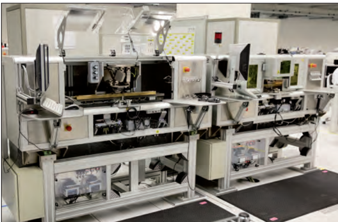
図10:各オープンタイプリニアエンコーダの内挿精度は、特別な検査ステーションで走査ヘッドを測定することにより得ることができる。
