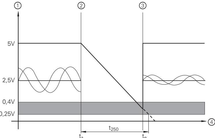
**Ein Start mit einer Betriebsspannung von größer 400 mV oder kleiner 250 mV ist unkritisch.**
